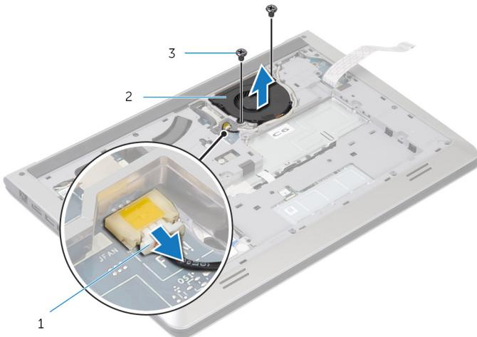
1 kábel ventilátora
